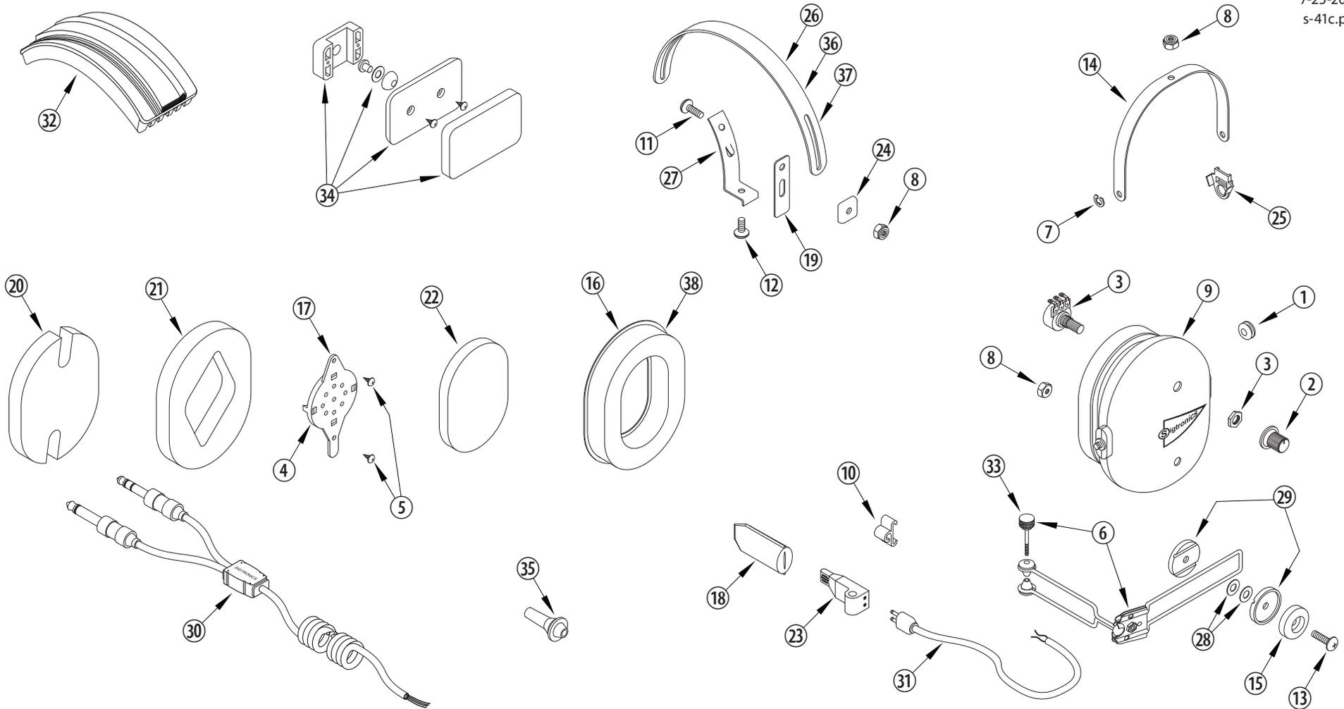
**SIGTRONICS S-41C HEADSET PARTS IDENTIFICATION BREAKDOWN**
